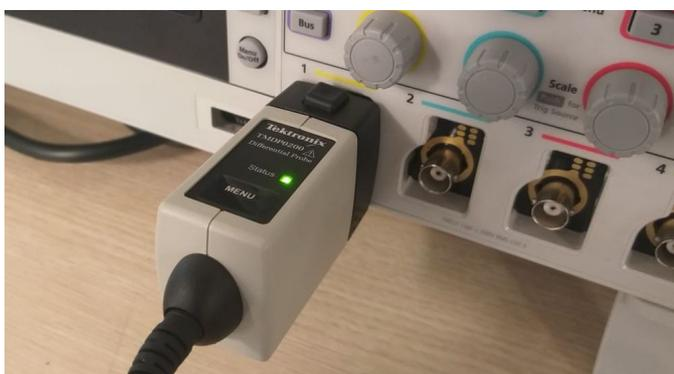
TekVPI-Tastköpfe übertragen Skaleneinstellungen, Bereiche und Statusinformationen zum TBS2000B-Oszilloskop.
