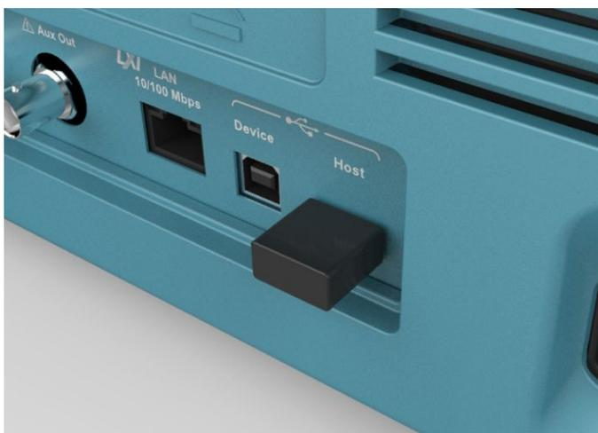
WLAN-Adapter werden über integrierte Setup-Menüs konfiguriert und unterstützen den nahtlosen WLAN-Datenaustausch
