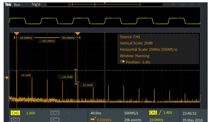
Das Quellsignal kann über dem FFT-Frequenzspektrum im Zeitbereich angezeigt werden.
