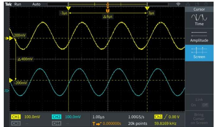
Die Cursormesswerte werden in der Signaldarstellung angezeigt. Cursor können zur Messung der Zeit und der Amplitude verwendet werden.
